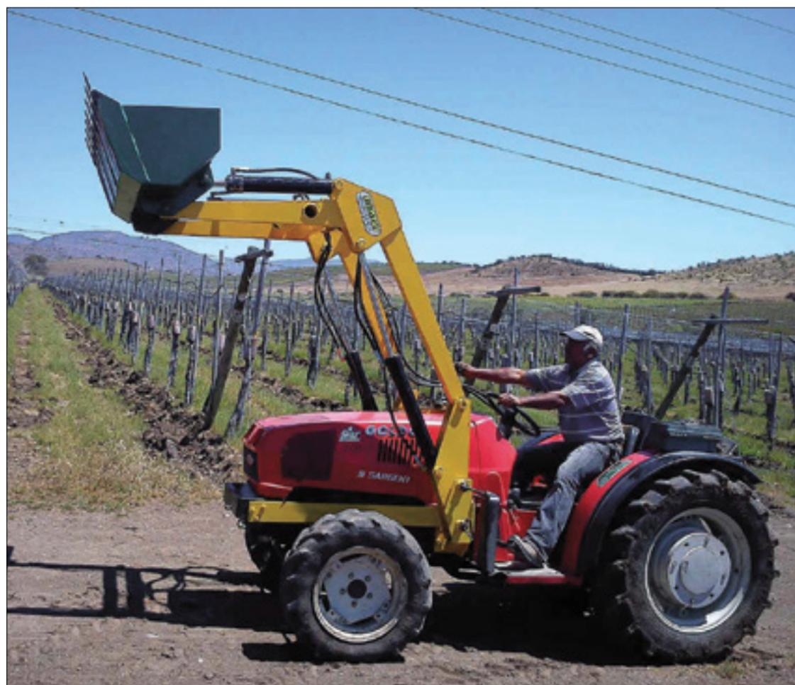
te se tiene la "altura de elevación" que es la altura del eje de giro del útil sobre el suelo en el punto de elevación máxima del brazo. La altura útil de carga es menor a la altura de elevación, debido precisamente al vuelco del útil.
